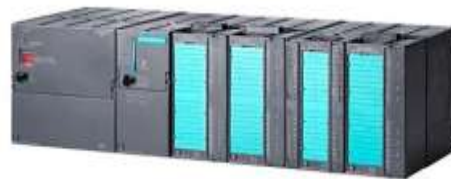
Fig. 2: Siemens S7-300 PLC
